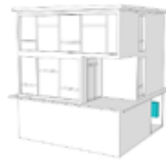
Verteilerkasten im Keller
